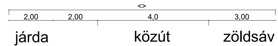
Tervezett kiszolgáló út mintakeresztmetszele belterületen
